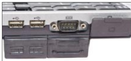
Alle Anschlüsse sind, soweit möglich, durch Gummilaschen geschützt
