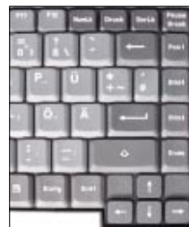
▲ Die Tastatur ist für längere Schreibarbeiten bestens geeignet, da der Tastenabstand dem Desktop-Standard entspricht
