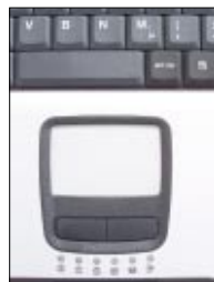
▲ Auch im Bereich des Touchpads haben Flüssigkeiten und Schmutz keine Chance, ins Gerät einzudringen
