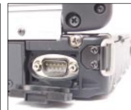
◀ Durch eine einzelne Gummilasche ist der Anschluss für einen externen Monitor oder Projektor geschützt
