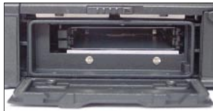
Zwei PC-Card-Schächte ermöglichen eine problemlose Aufrüstung mit Typ-II- und Typ-III-Karten
