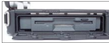
Ein Diskettenlaufwerk steckt serienmäßig im Modulschacht - ein optisches Laufwerk gibt es nur gegen Aufpreis
