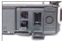
◀ Tief ins Gehäuse hat Panasonic die Modem- und die Netzwerkbuchse sowie den USB-Port gelegt
