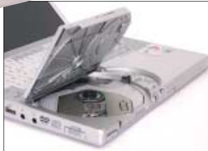
▲ Die Handballenaufgabe lässt sich nach oben öffnen, und schon ist der Zugriff auf das Combo-Laufwerk frei
