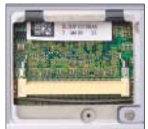
Auf maximal 512 MByte lässt sich der Arbeitsspeicher aufrüsten ▶
