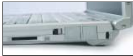
Rechts befinden sich der PC- und der SD-Card-Steckplatz, die Netzwerk- und die Modem-Buchse sowie das Kensington-Lock
