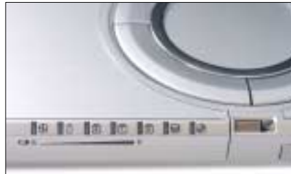
Nicht weniger als sieben Kontroll-LEDs sowie die Akku-Ladestandsanzeige sind an der Vorderseite platziert
