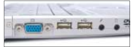
▲ Links reihen sich der Monitor-Anschluss, die beiden USB-2.0-Ports und die Audio-Schnittstelle nebeneinander
