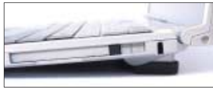
Der Blick von rechts zeigt den PC-Card-Schacht sowie die Schrägstellung durch den Akku an der Rückseite
