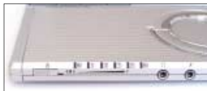
An der Vorderseite sind der Netzschalter, Kontroll-LEDs und Audio-Anschlüsse platziert
