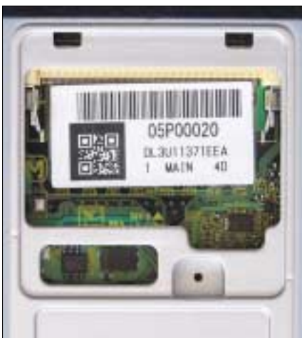
Der gut zugängliche Steckplatz an der Unterseite ermöglicht die Aufrüstung des Arbeitsspeichers um weitere 256 MByte
