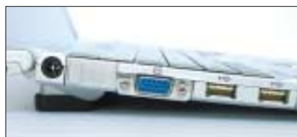
Die Buchse für den Netzteilstecker, der Monitoranschluss sowie die beiden USB-Ports sind an der linken Seite zu finden
