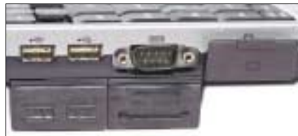
Die zwei USB-Ports, die serielle Schnittstelle und der Monitor-Anschluss sind einzeln durch Gummilaschen geschützt
