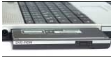
Das DVD-ROM-Laufwerk steckt in einem Modulschacht
