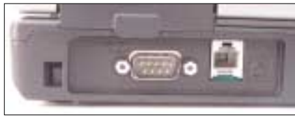
Echte Rarität: Als eines von nur wenigen aktuellen Notebooks verfügt das aktuelle Toughbook über eine serielle Schnittstelle.
