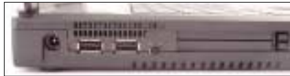
Stromanschluss, USB-Ports, Firewire-Schnittstelle und PC-Card-Steckplätze sind an der linken Seite zu finden
