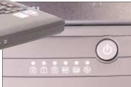
Unterhalb des Stromschalters sind sechs Kontroll-LEDs platziert
