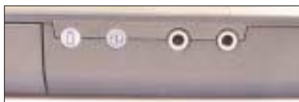
Zwei weitere Kontroll-LEDs und die Audio-Anschlüsse hat Panasonic an der Vorderseite positioniert
