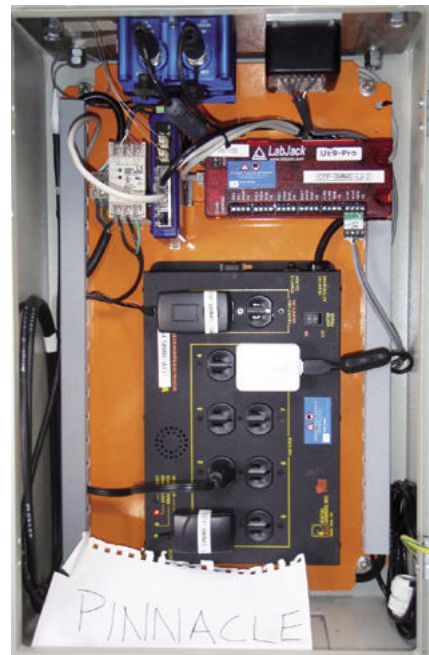
Fotografia 4. Urządzenie mierzące odchylenia i wibracje iglicy budynku Burj Khalifa zbudowane w oparciu o moduł LabJack
